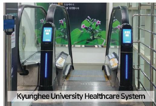
► **STÉRILISATION ET NETTOYAGE** par rouleaux imprégnés d'une solution stérilisante détruisant 99% des germes et virus avec passage sous une lampe UV LED
